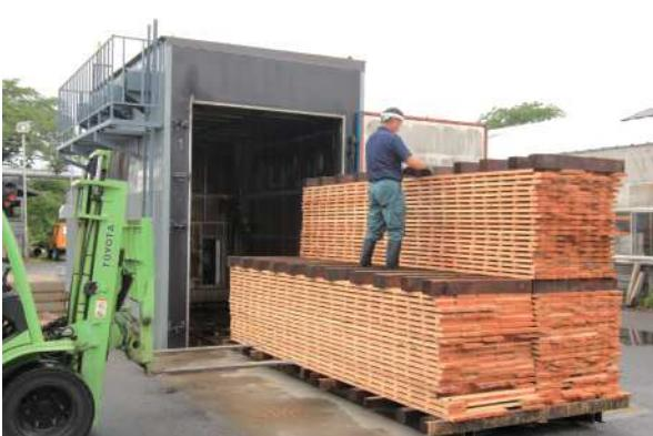
乾燥は4日間をかけてゆっくりと。乾燥機に入れた後、中温乾燥となる85℃の蒸気を木全体に浸透させ、全ての木の含水率を一定に高める。残りの3日間をかけ、飽和状態になった水分を徐々に抜いていく。湿度を1時間ごとにコントロールしながら、最終日には含水率12%まで下がっていく。
